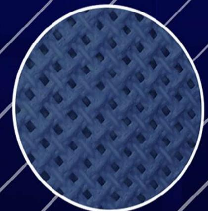
Произведены из ткани с ПВХ покрытием и винилового сетчатого полотна **MESH**
