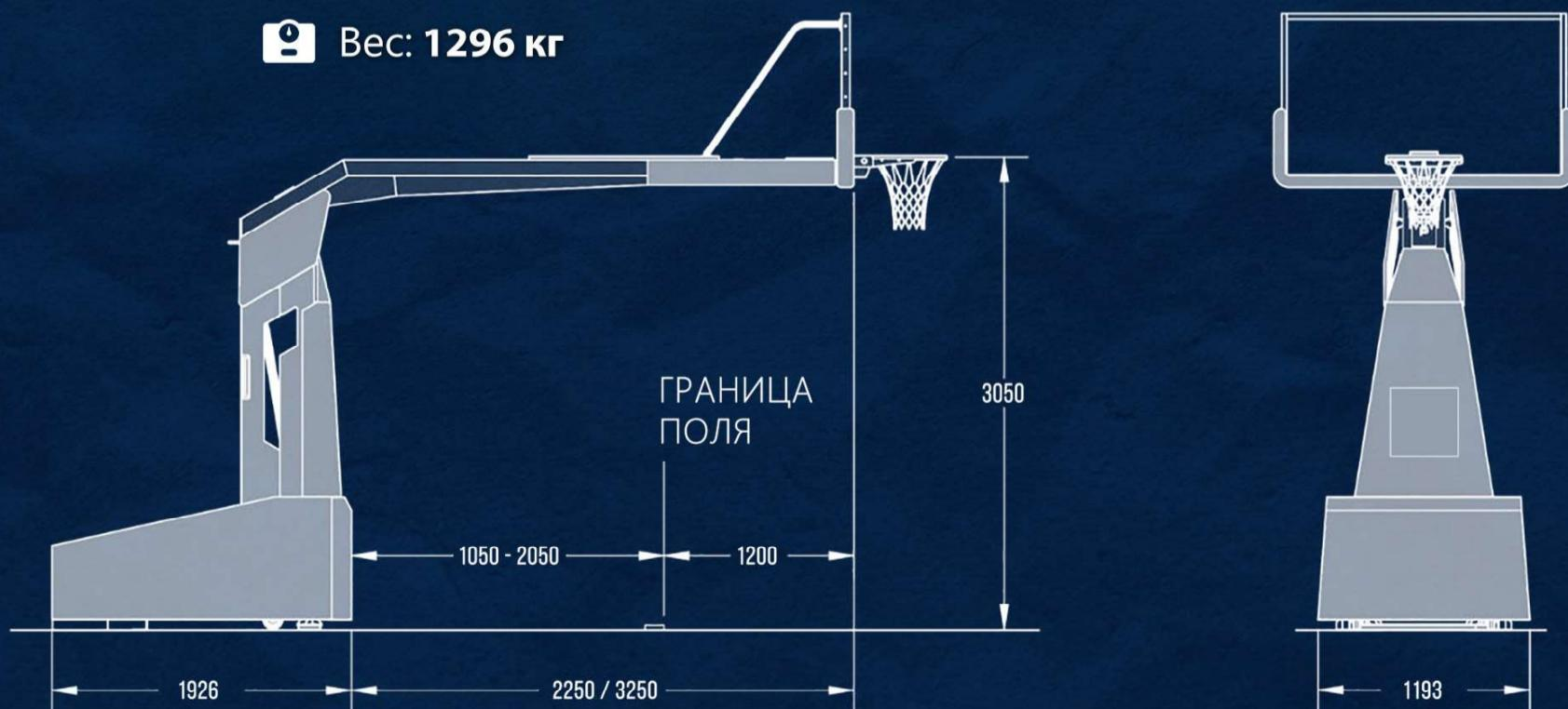
Производится в двух вариантах с выносом 2250 / 3250 мм
